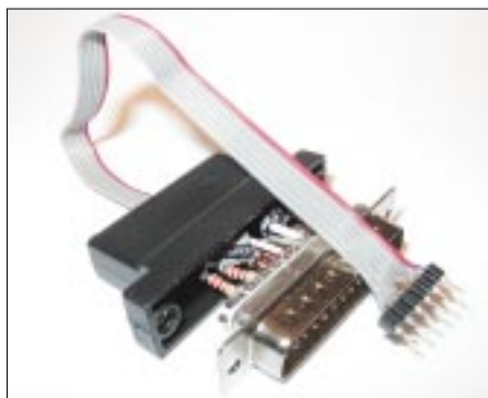
Bild 5: Das Programmiergerät findet seinen Platz in einem 25poligen SUB-D-Steckverbinder.
