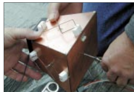
Die Sendeantenne für ATV. Im Inneren ist die S/W-Kamera installiert. Fotos: OE2TZL
