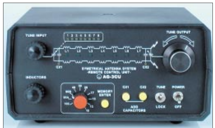
Bild 3: Erst mit dem in Sendernähe unterzubringenden Bedienteil ist das Abstimmsystem komplett. Die aufgedruckte Schaltung und die vielen Kontroll-LED vermitteln das Gefühl, den Abstimmprozeß „im Griff“ zu haben.
