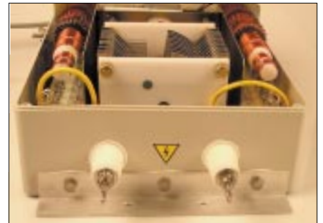
Bild 7: An der Kopfseite des Tuners befinden sich zwei Flügelmuttern für den Anschluß einer symmetrischen Antenne bzw. Hühnerleiter.
