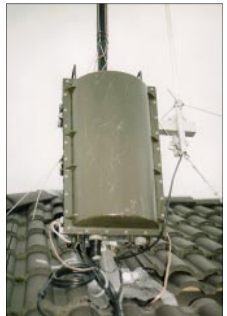
Bild 2: Der Tuner am Fußpunkt einer 8,6 m langen Vertikalantenne auf dem Dach des Autors. Rechts im Bild eine X-30 Vertikal für VHF/UHF.
