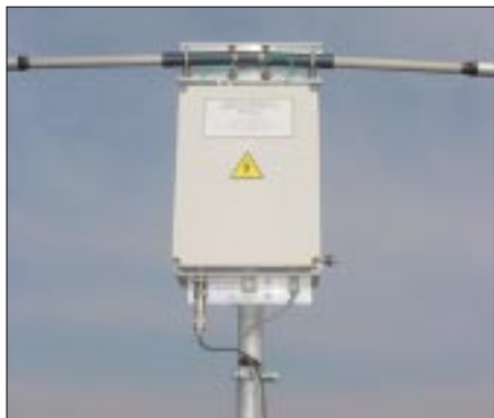
Bild 4: AG-3 im Speisepunkt eines selbstgebauten Drehdipols mit 2 \times 6,50\text{ m} Länge Fotos: DK7ZB (2), DL2RD (3)
